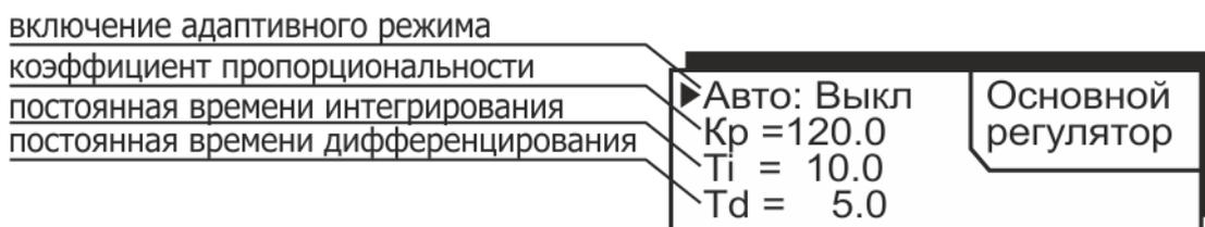
Рисунок 14 — Параметры ПИД-регулятора
