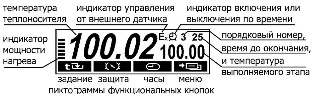
Рисунок 5 — Дисплей в режиме регулирования по программе
