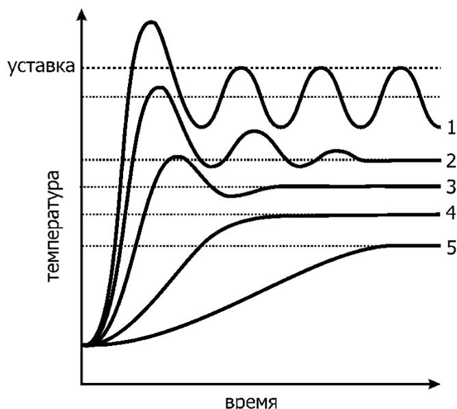
Рисунок 15 — Определение  $K_p$
